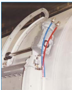
ouverture des portes motorisées
